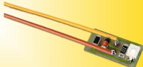
**Platine mit zwei LEDs für Hausbeleuchtung:**
